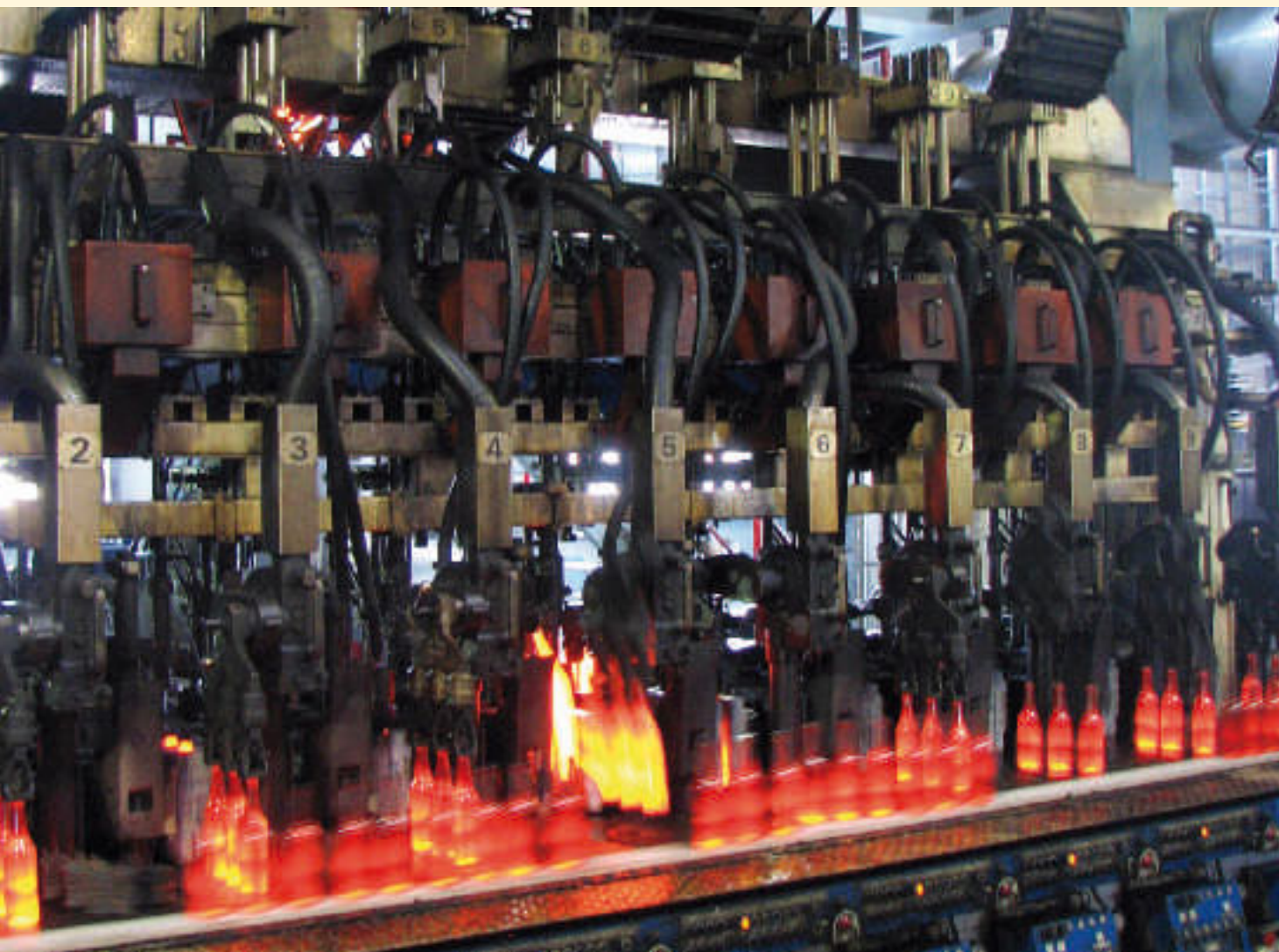
Die erste Triple-Gob-Maschine der Vetropack-Gruppe: Am Heissen Ende können jetzt gleichzeitig drei Glasflaschen pro Zyklus geformt werden.
